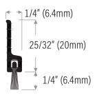
DS110AP Extruded aluminum mill finish with pile insert, blackDS110DP Bronze anodizedDSP10BL Replacement pile insert, black
