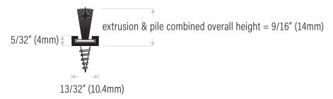
DS369A7550G Aluminum extrusion mill finish with fin pile insert, grey
