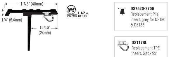
**DS180CT** Extruded aluminum clear anodized with TPE (T) insert Lengths available: 84" (2134mm), 96" (2438mm) & 180" (4572mm) DS180 & DS185
